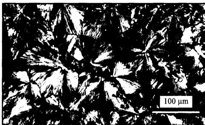
**Figure 5.6:** polypropylène PPU 1752 S2 après fusion et recristallisation
