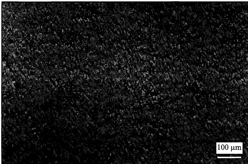
**Figure 6.38:** surface polie d'un échantillon du mélange PP/PA/PPgMA: 89/6/5 (pas d'attaque chimique)
