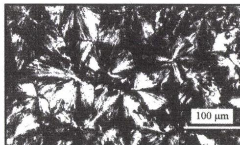
**Figure 4.13:** polypropylène à température ambiante
