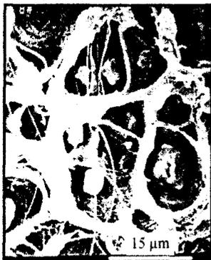
**Figure 6.71:** PEhd chargé avec 10% de  $\text{CaCO}_3$  [143]
