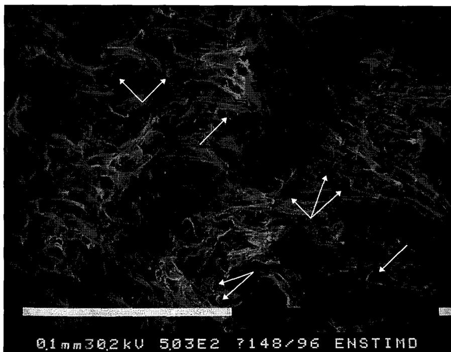
**Figure 5.7:** fractographie du polypropylène PPU 1752 S2
