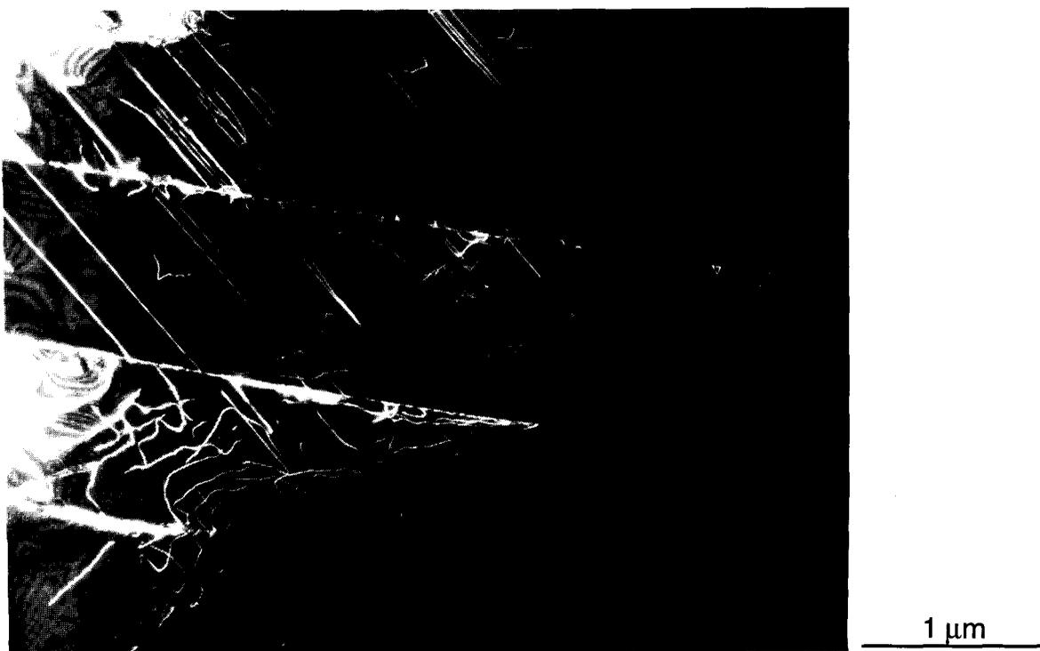
Figure 8 : Micrographie électronique en faisceau faiblement excité ( $g = 004$ ) montrant une famille de défauts plans extrêmement fins parallèles au plan (111).
