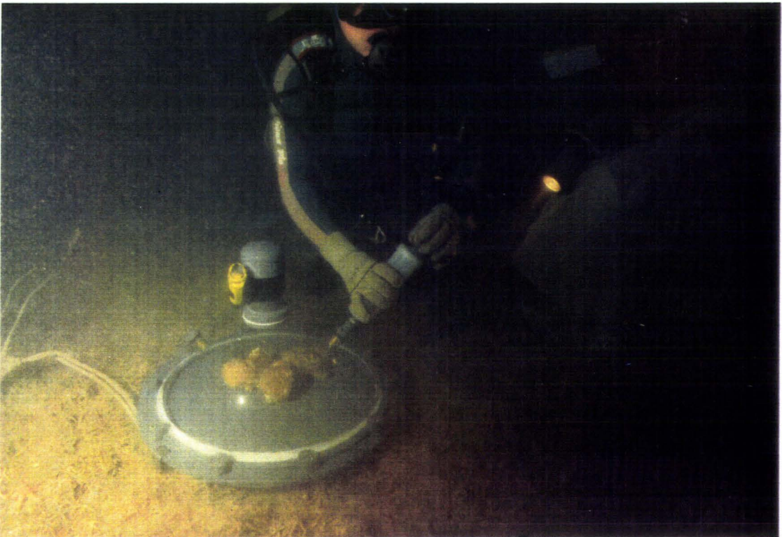
Figure 6 : Prélèvement à la seringue dans la chambre benthique. (Cliché A. Richard)
