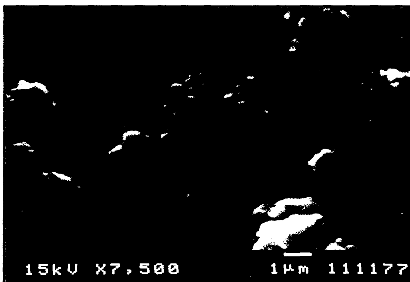
Figure 1.13 : Analyse au microscope électronique à balayage de l'hydroxyde de magnésium Zer60.
