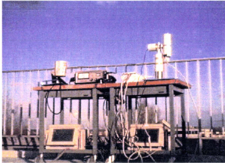
Figure IV.1: Le prototype CLIMAT et le radiomètre Barnes PRT-5 sur le toit du Laboratoire.
