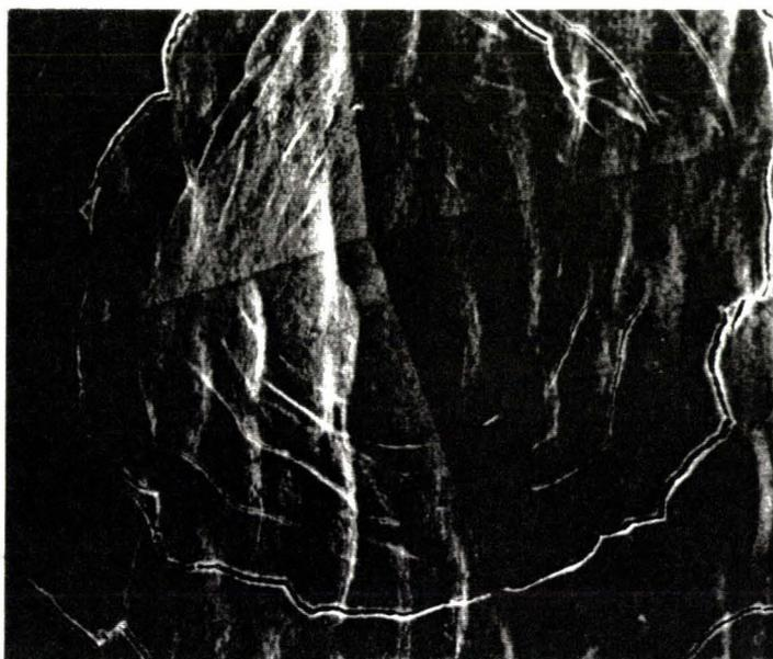
Fig. 14 : Observation d'une empreinte Vickers sur un dépôt de chrome montrant l'existence de fissures ce qui justifie le choix de la constante C.
