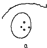
Figure 2-23 : Contours après seuillage par hystérésis. Seuil haut=67, seuil bas= 15. Opération sur image bruitée.
