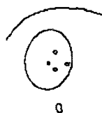
Figure 2-24 : Contours après seuillage par hystérésis. Seuil haut=67, seuil bas =15. Opération sur image originale.
