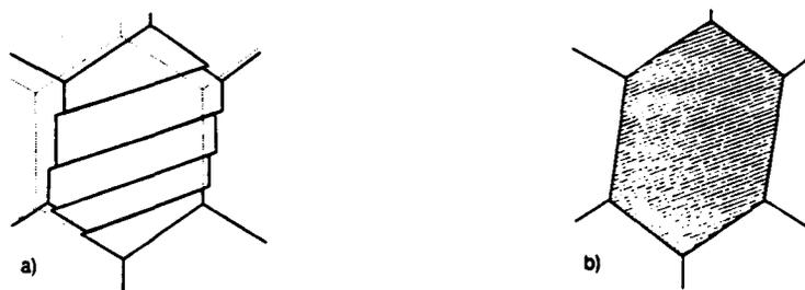
Figure IV-19 : Schématisation de la déformation plastique d'un grain où le glissement est plan ; (a) faible nombre de plans de glissement (forte localisation), (b) glissement plan finement distribué (faible localisation) [CHRIST 96]
