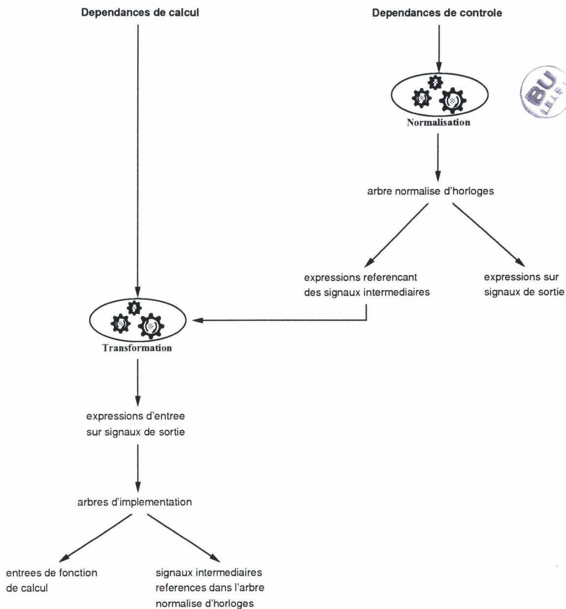
FIG. IV.7 - Chaîne de transformation des dépendances de contrôle et de calcul.
