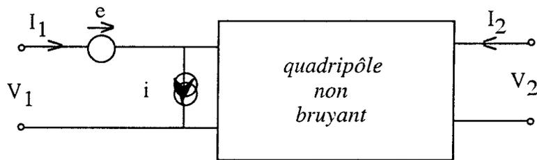
figure 35 : Circuit de bruit équivalent (représentation chaîne)
