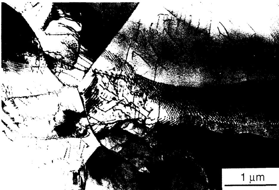
Figure III-46: Microstructure observée en MET dans l'alliage de départ.
