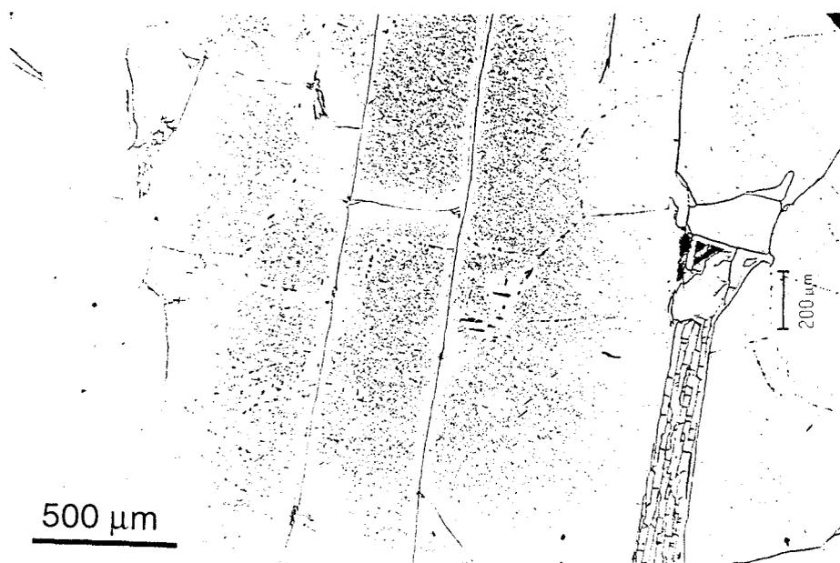
Figure III-27: Répartition des phosphures dans les grains de kamacite.
