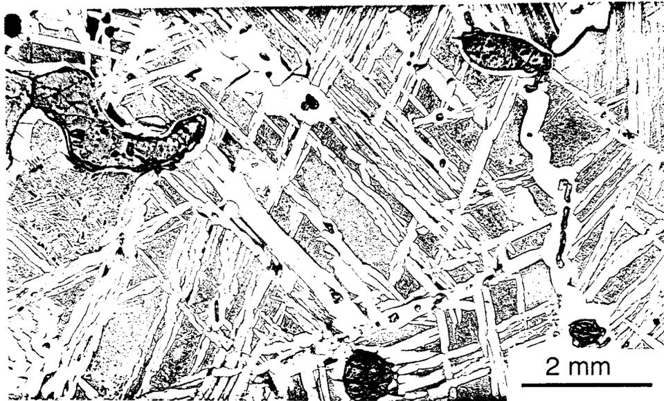
Figure III-16-a: Figures de Widmanstätten dans Montdiou (noter les grains de FeS).
