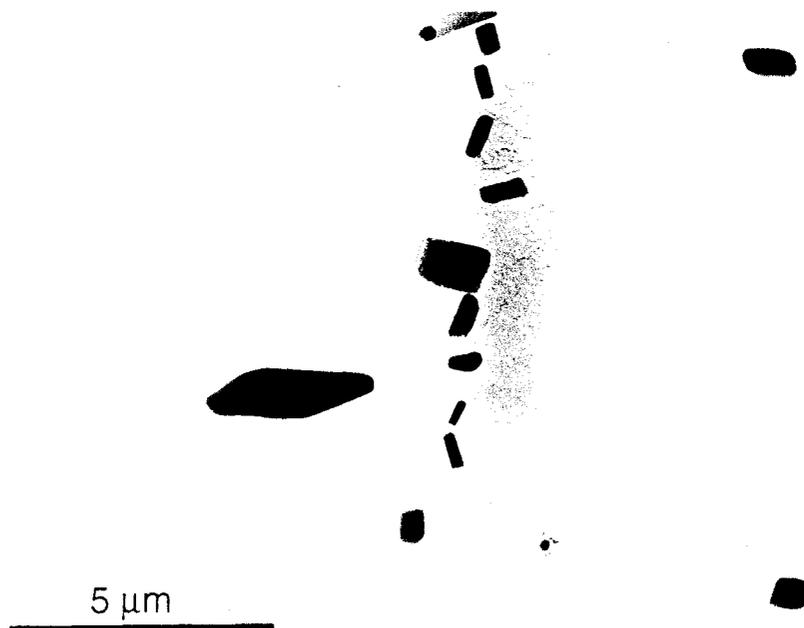
Figure III-14-a: Alignement de phosphures  $(\text{Fe,Ni})_2\text{P}$
