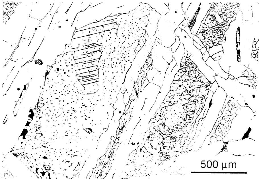
Figure III-21: Bandes de Neuman faiblement déviées par des sous joints (Gibeon).
