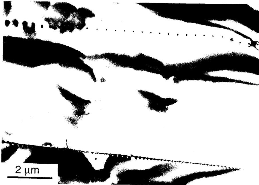
Figure III-3: Sous joints dans un grain d'olivine (Brahin).
