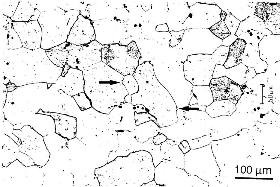
Figure II-3: Microscopie optique; joints de phase kamacite-taenite (flèches) et joints de grains dans la kamacite révélés par une attaque au nital-picral (alliage synthétique).
