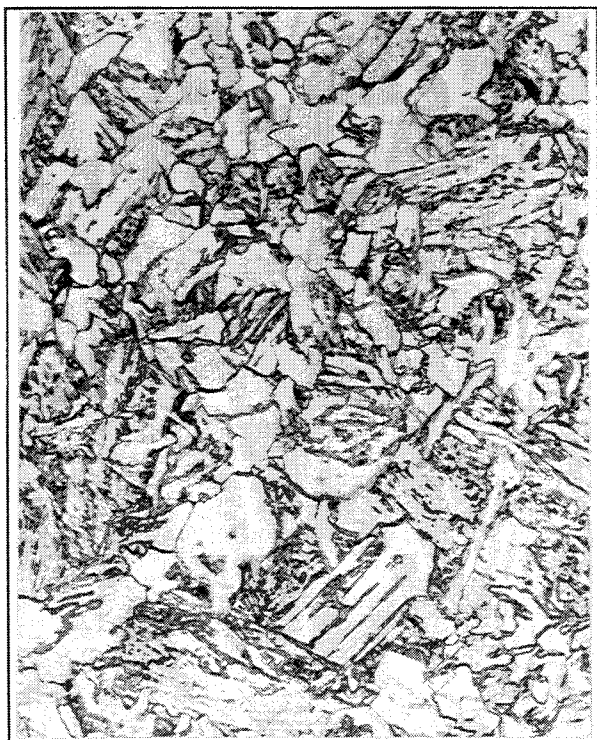
Fig 7e : Microstructure de matériau TT3 ( \times 400 ). (195 HV20).
