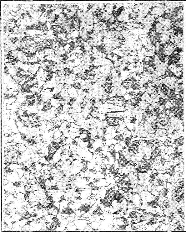
Fig.7a : Microstructure à l'état brut de livraison.( \times 100 ).
