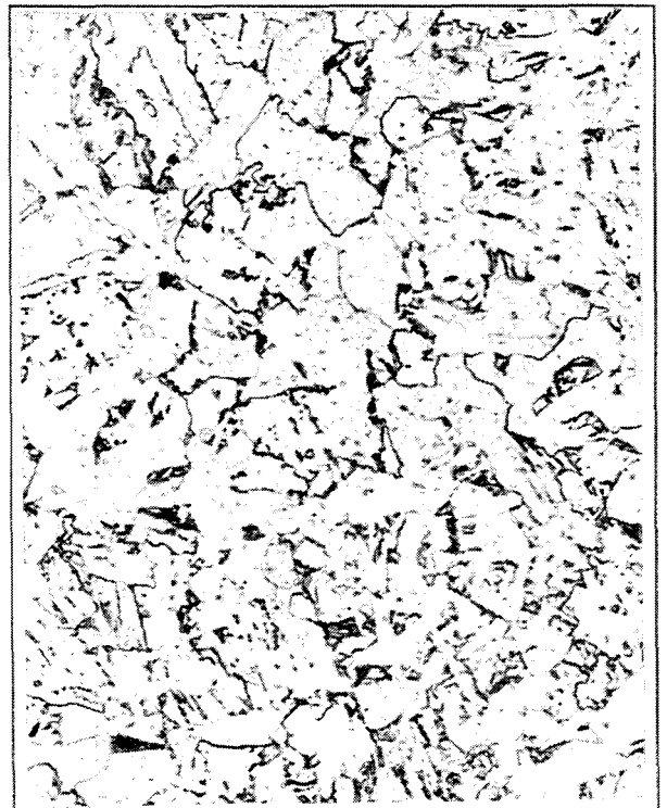
Fig. 7d. : Microstructure de matériau TT3. ( \times 400 ). (195 HV20).
