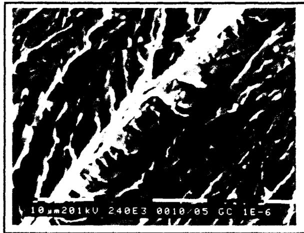
Figure I.7: Endommagement à potentiel libre de l'acier galvanisé ( $\dot{\epsilon} = 10^{-6} \text{ s}^{-1}$ ). Rivière cristallographique.
