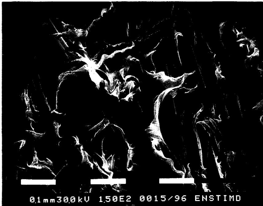
fig V28: Décohésion fibre/matrice au niveau de la ligne de soudure d'une éprouvette injectée dans les conditions minimales. 1 tiret blanc représente 0,1 mm.
