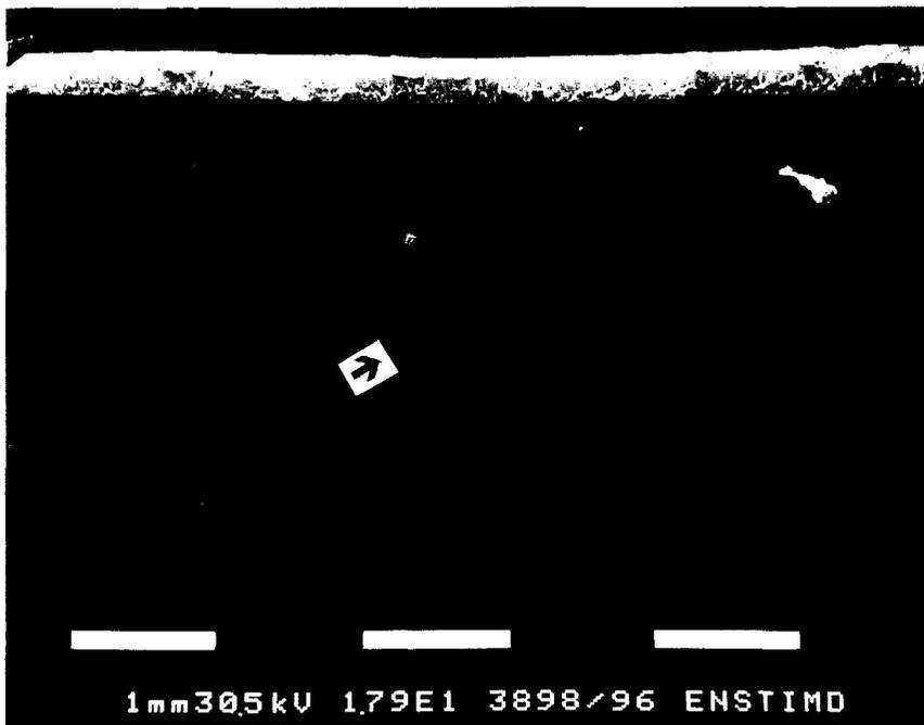
fig III.25: Faciès de type miroir d'une éprouvette de Polystyrène sans ligne de soudure. Au centre, présence d'un microdéfaut. 1 tiret blanc représente 1 mm.
