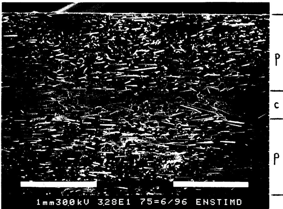
fig V.44: Faciès de rupture hors ligne de soudure d'une éprouvette injectée en conditions maximales et sollicitée en choc Charpy. 1 tiret blanc représente 1 mm.
