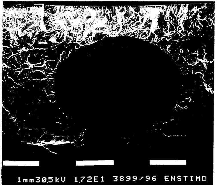
fig III.31: Faciès de rupture d'une éprouvette de PS avec ligne de soudure sans rainure. Température d'injection: 290°C
