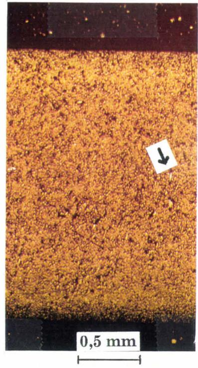
fig V.10: Coupe polie hors ligne de soudure. Effet de bord. Plan (xz).
