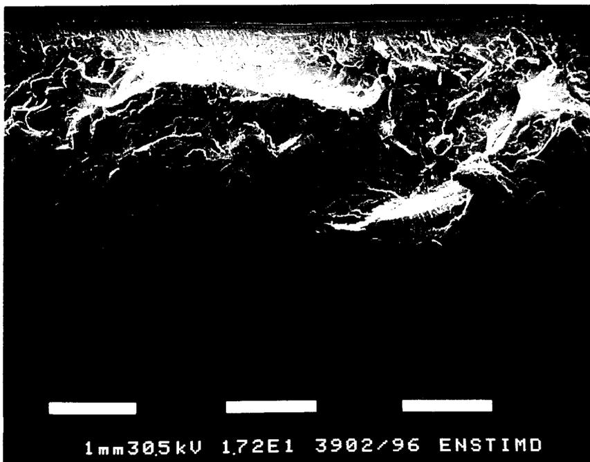
fig III.27: Faciès de rupture d'une éprouvette de Polystyrène avec ligne de soudure frontale et rainure. 1 tiret blanc représente 1 mm.
