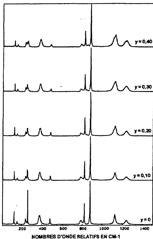
Fig. 3 : Evolution du spectre Raman et de la luminescence ( \lambda_{\text{exc.}} = 647,1 nm) en fonction du taux d'Arsenic dans \text{EuV}_{1-y}\text{As}_y\text{O}_4 .
