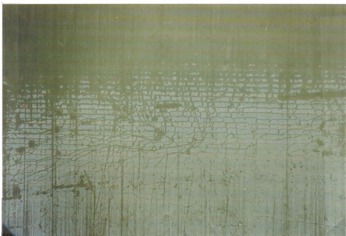
Figure V.14 : Transition TGB_A -BP pour le composé n = 9 ( T = 68.3 °C). La transition se fait à partir de l'arête et des fils de Grandjean-Cano. Le pas est de l'ordre de 0.14 \mu\text{m} en phase TGB_A .
