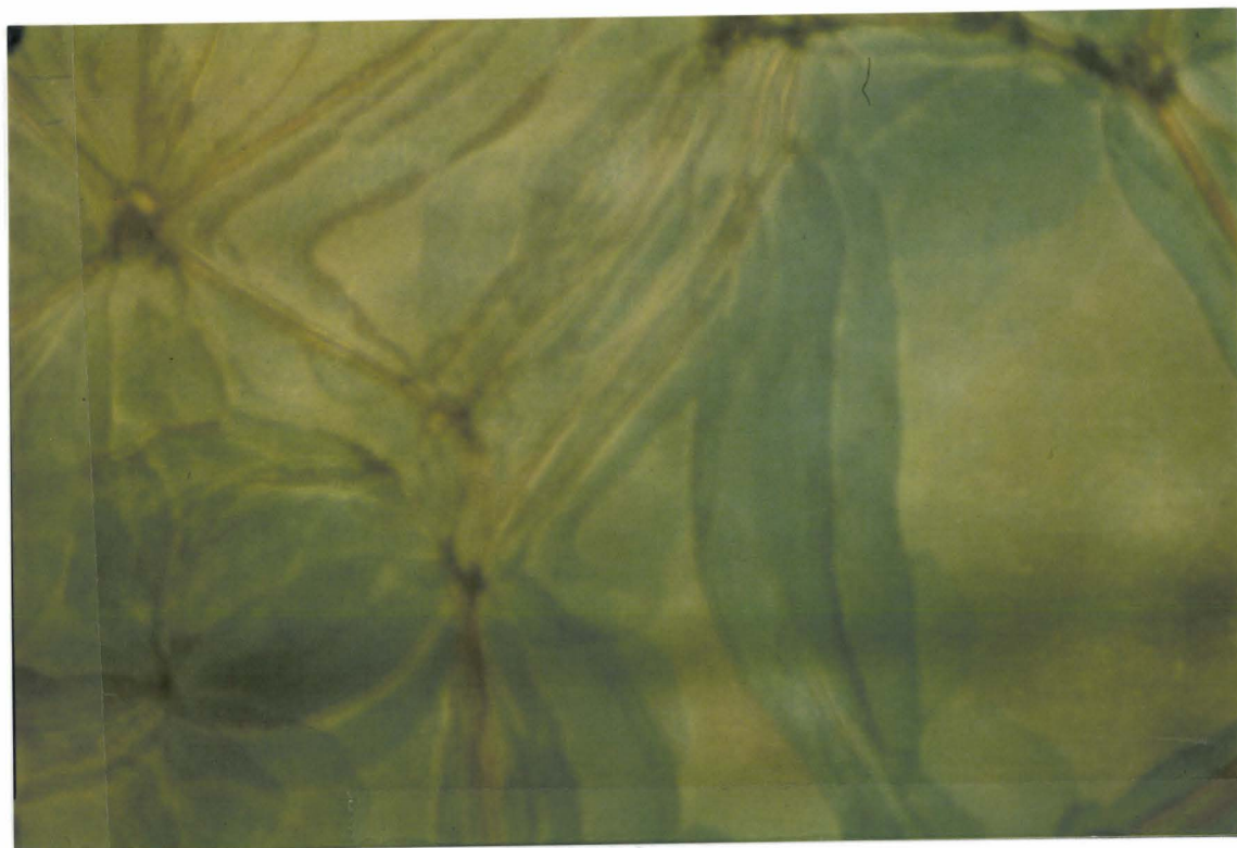
Photo IV.1-1 : Transition TGBA-TGBC : un amas bleuté recouvre la totalité de l'échantillon, le temps de la transformation (composé 11F_2 )
