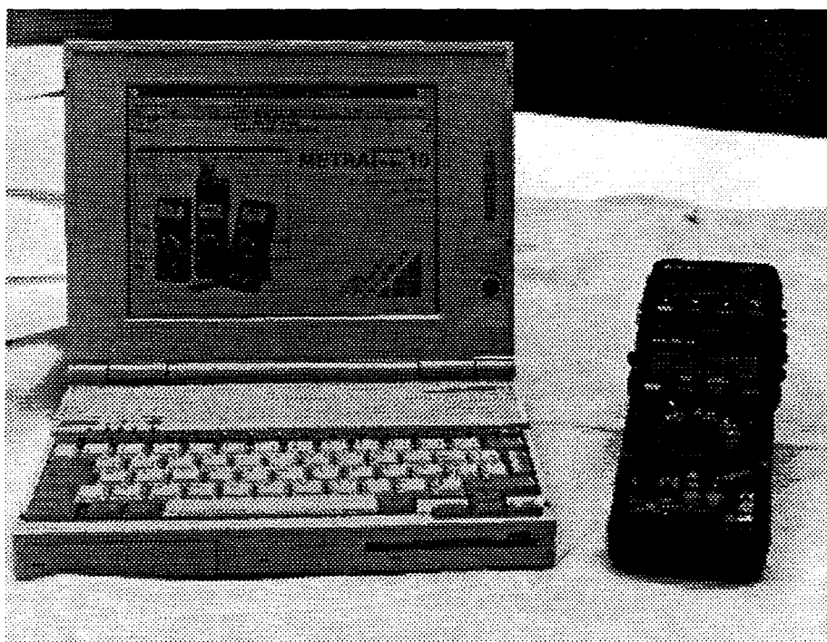
Figure III.9 Multimètre MetraHit 15S piloté par le logiciel MetraWin 10 d'un ordinateur portable
