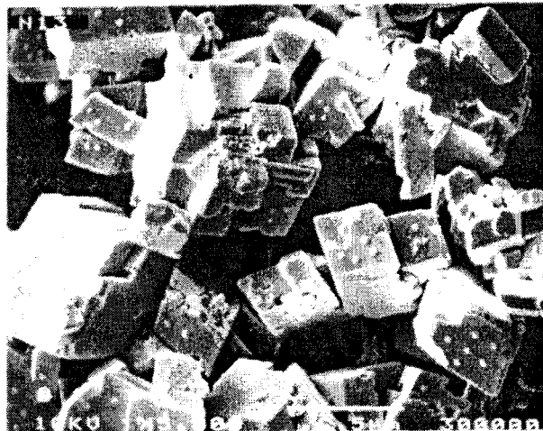
Figure II-2 : Microphotographies MEB montrant l'évolution morphologique des solides [récupérés par filtration] au cours de la transformation cristalline de la vatérite en suspension dans une solution de chlorure de manganèse (II) de concentration égale à 10^{-4}M . Temps de réaction : a) 6h; b) 24h ; c) 4 jours.
