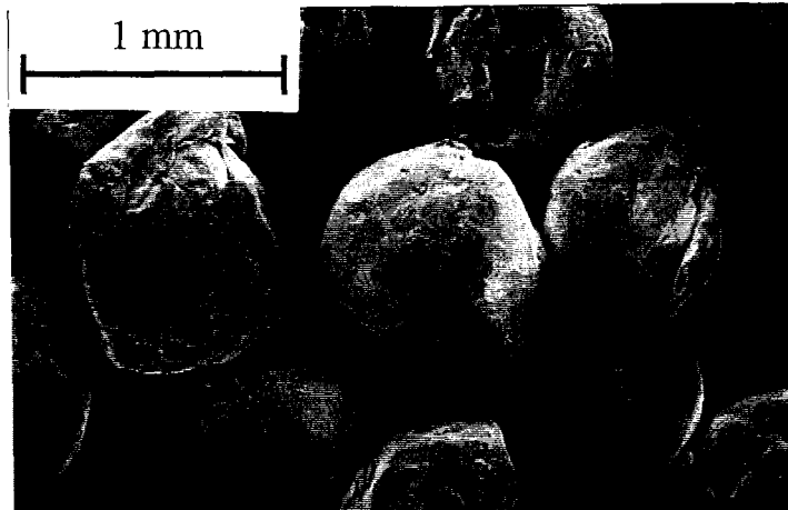
figure V.A.1 : bille résultant de l'équilibre en fréquences de collage et fracture .
