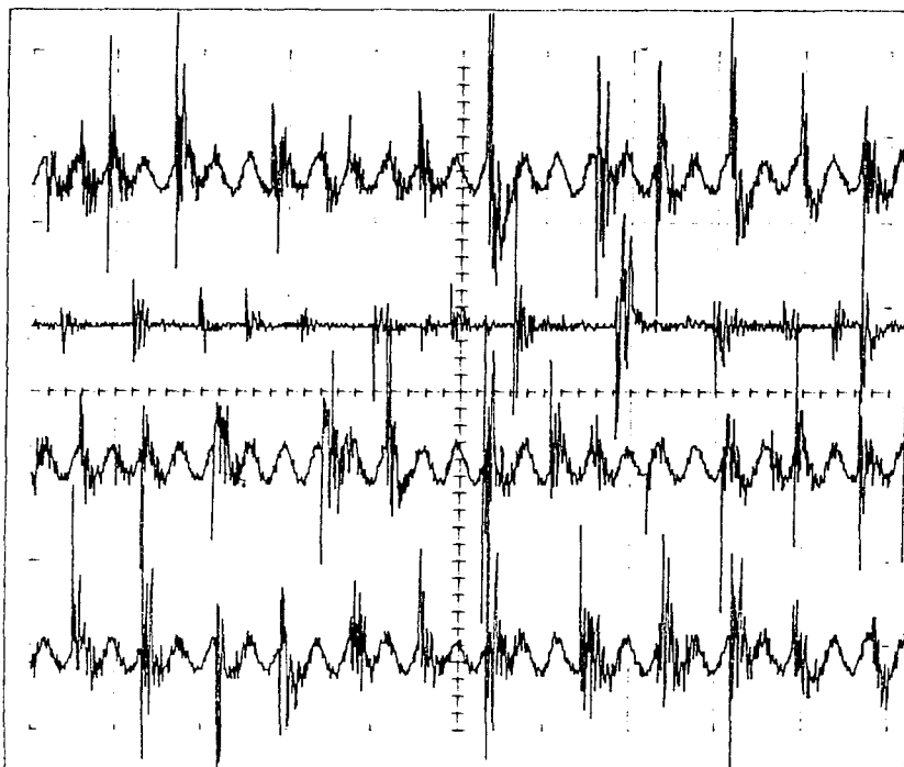
figure III.B.3 : Un exemple de sonogramme : au signal de 50 Hz, correspondant au broyeur, se superposent des signaux amortis qui correspondent aux chocs bille-poudres. La fréquence est estimée en comptant ces événements sur un temps suffisamment long.
