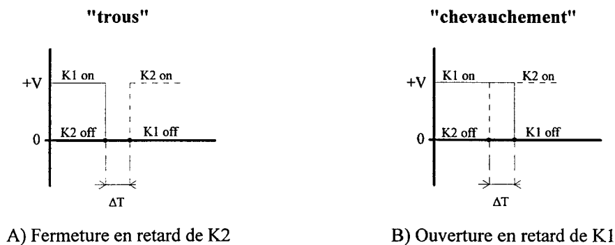
Figure 1.15 : Décalage des commandes appliquées sur les interrupteurs K_1 et K_2
