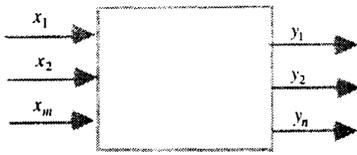
Figure 6.1.a : une représentation d'un élément actif recevant  $m$  flux en entrée et produisant  $n$  flux en sortie. A chaque flux est attribuée une variable caractérisant l'état de ce flux.
