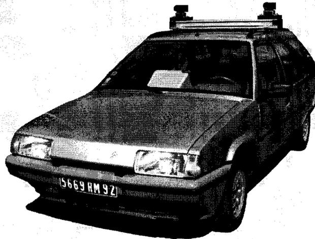
Figure III-5. La voiture utilisée pour les essais de prise de vue. Noter le stéréoscope linéaire sur le toit, et le moniteur VGA à la place du passager avant.
