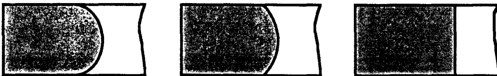
Fig. 3.48: Evolution de la fissuration dans le cas d'un défaut d'amorçage extérieur
