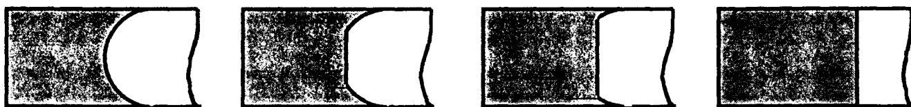
Fig. 3.49: Evolution de la fissuration dans le cas d'un défaut d'amorçage intérieur
