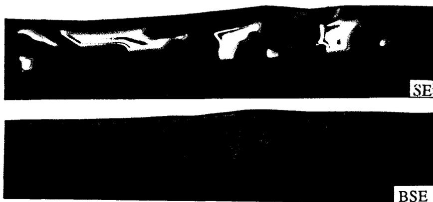
Figure IV-14 : Micrographies (images des électrons secondaires et des électrons rétrodiffusés) de la section transverse du matériau après un traitement flash de 1 min à  $860^\circ\text{C}$
