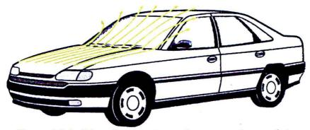
Figure 5.2.2: Filets d'air au niveau du capot et du pare-brise
