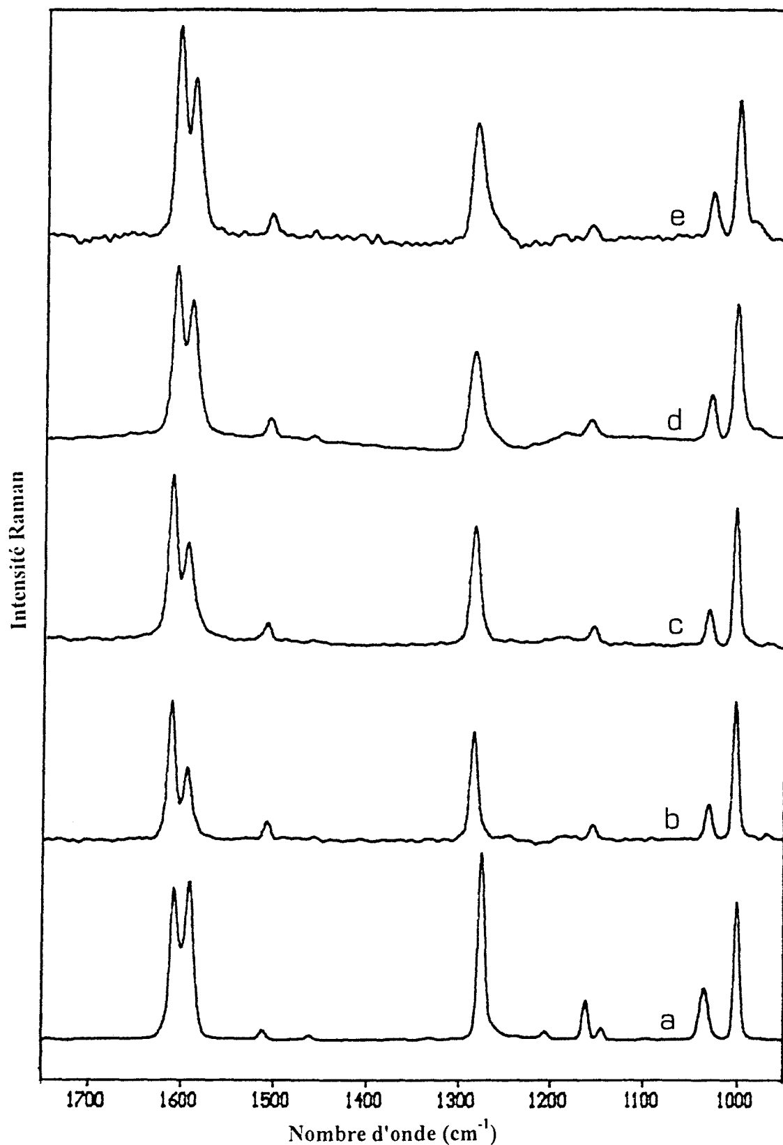
figure 1: spectres FT-Raman du biphenyle sur le domaine 1750-950 \text{cm}^{-1} . Solide microcristallin (a), solution dans \text{CHCl}_3 (0,13 \text{mol.l}^{-1} ) (b), adsorption dans FAU (c), \text{Na}_{56}\text{FAU} (d) et \text{Na}_{85}\text{FAU} (e) (8 molécules par maille unitaire).
