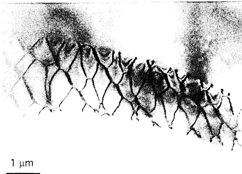
*figure V.15 : Grenat des éclogites des Alpes. Sous-joint. CC.  $g = 400$ .*
