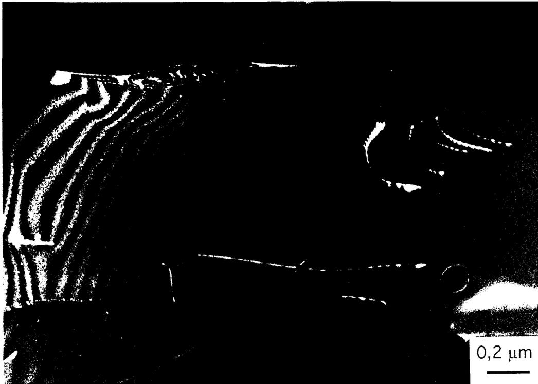
*figure VI.12 : Majorite de la météorite Acfer. Dislocations dissociées émises par un joint de grain. CNFF.  $g = 400$ .*
