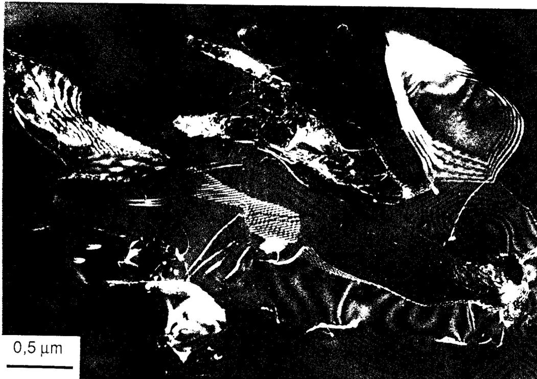
*figure VI.11 : Majorite de la météorite Acfer. Sous-joints organisés en cellules. CNFF.*
