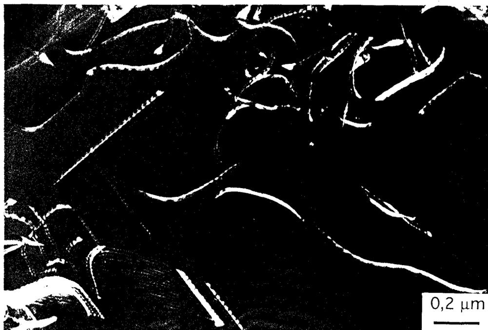
*figure V.8 : Grenat des éclogites des Alpes. Forte concentration de dislocations près d'une fissure (non visible sur le cliché). CNFF.  $g = 400$ .*
