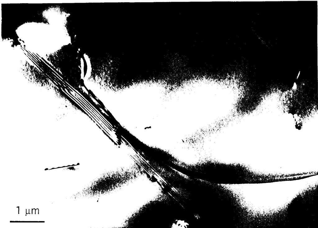
*figure V.31 : Grenat de Koidu. Large ruban de faute. CC.  $g = 400$ .*
