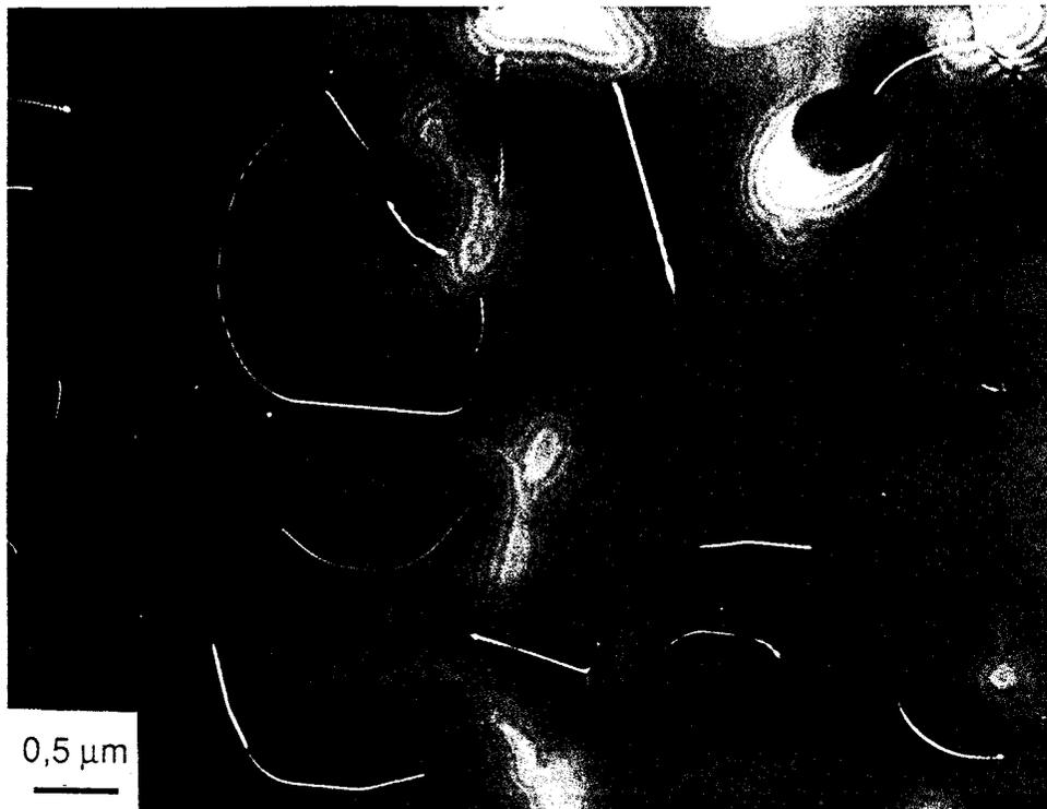
*figure III.6* : Echantillon D5. Lamme parallèle à  $\{110\}$ . Boucles de dislocations. CNFF.  $g = 400$ .
