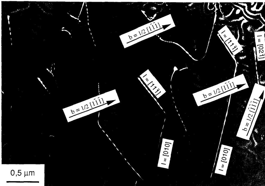
*figure IV.13 : Essai à 1100°C (2826). Boucles de dislocations. CNFF.  $g = 400$ .*
