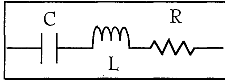
Figure 22-II : Schéma HF équivalent d'un condensateur
