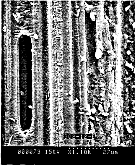
Figure II-5 : bulles (observation sur éprouvette rompue)
