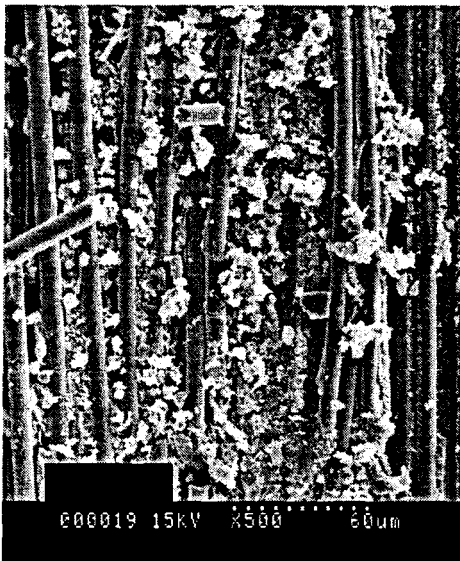
Figure II-8 : désalignements de fibres (observation sur éprouvette rompue)
