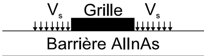
Figure IV-52 : utilisation de potentiel de surface dans le transistor planar pour simuler la présence de recess.
