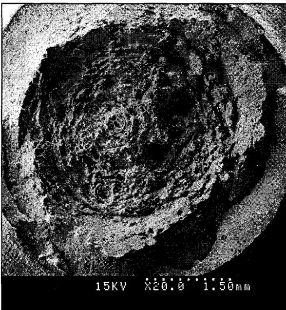
Figure II-47 : Faciès de rupture en "cup and cone" d'une éprouvette AE4 en acier 16MND5 rompue à température ambiante.
