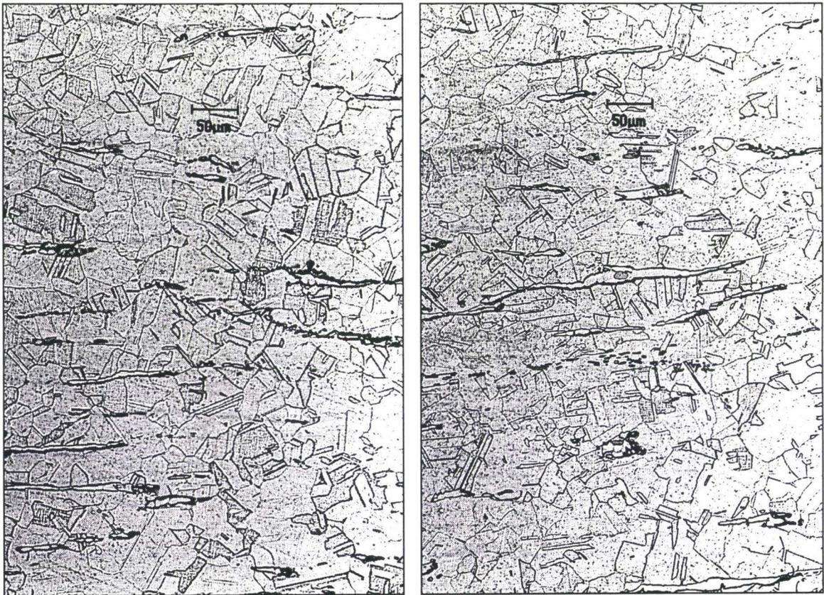
Figure II-12 : Microstructure de l'acier 316Nb-RV dans une section tangentielle longitudinale.
