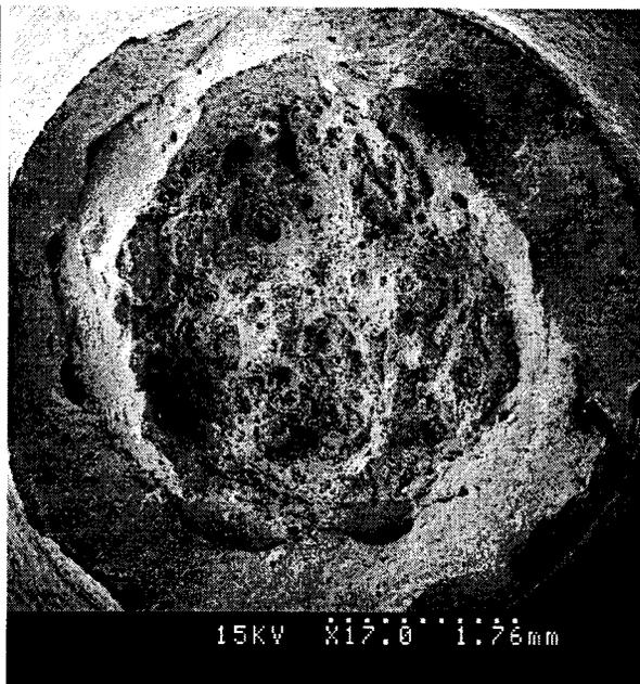
Figure B-34 : Faciès de rupture d'une éprouvette AE4. Acier 16MND5. 280°C.
