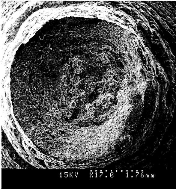
Figure B-40 : Faciès de rupture d'une éprouvette AE2. Acier 316L. 280°C.
