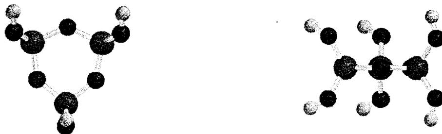
Figure II-18 : Anneau de silice à trois tétraèdres vu de dessus et de côté
