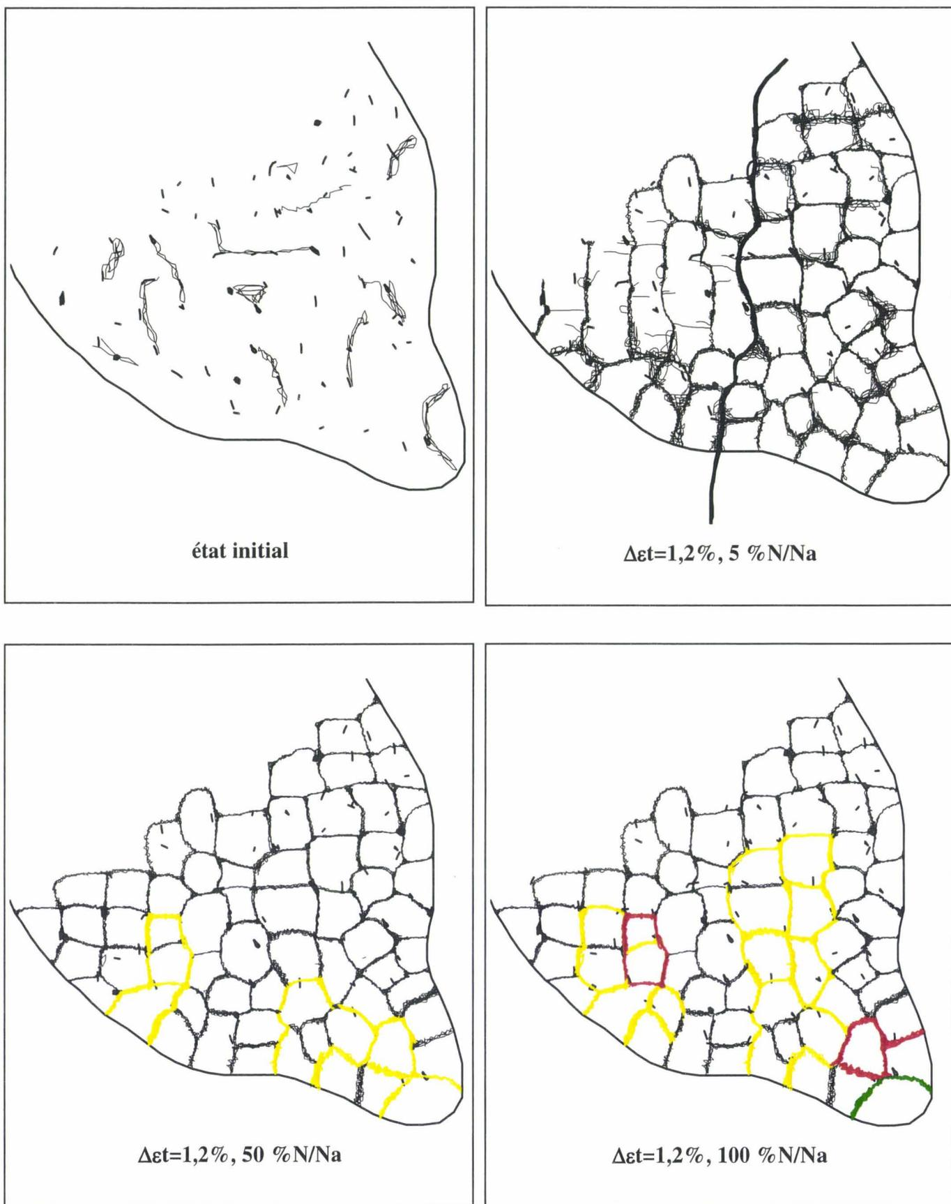
Figure 16 : Schématisation des évolutions microstructurales dans la ferrite du matériau essentiellement ferritique VF95 au cours du cyclage de fatigue oligocyclique à chaud.
