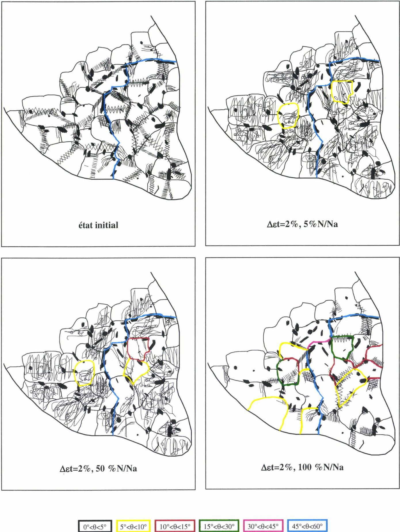
Figure 22 : Schématisation des évolutions microstructurales dans la bainite du matériau de référence au cours du cyclage de fatigue oligocyclique à chaud.
