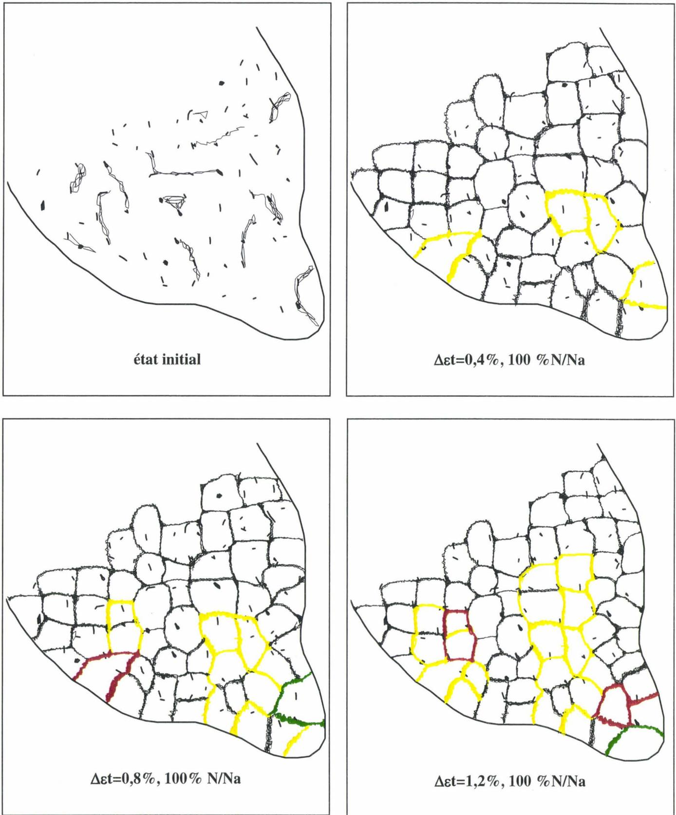
Figure 17 : Schématisation de l'influence de la variation de la déformation sur les évolutions microstructurales de fatigue oligocyclique à chaud dans la ferrite du matériau essentiellement ferritique VF95.
