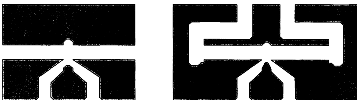
Epaississement des contacts métalliques
