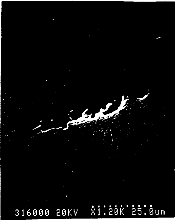
Fig. AI - 1 : Inclusion de type « aluminate » et relevé spectrométrique associé
