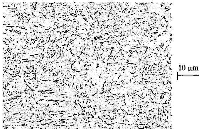
Fig. IV - 15 : Micrographies de la ZAT gros grains grenailée côté 2 ème passe après traitement de 45 min à 500°C
