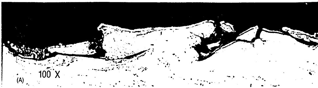
Fig. I - 71 : Endommagement en surface lié à un mauvais grenailage [LEG93]
