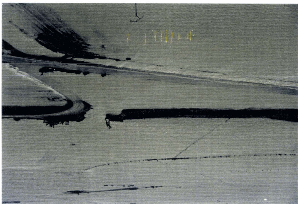
Fig. 99: La vanne du Canal de Cayeux a cédé: les eaux se répandent vers le nord des Bas (Champs et recouvrent la route D102.(photo aérienne, D.D.E. de la Somme, Subdivision Maritime)
