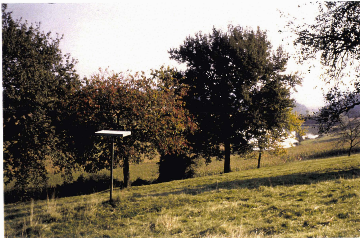
Photographie 1 - Grélimètre en place dans les Hautes-Pyrénées Hauteur du support : 1,5 m. Surface de la plaque : 1040 cm 2 (cliché : ANELFA)
