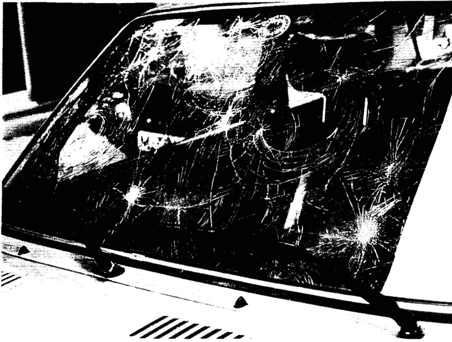
Photographie 6 - Dégâts de la grêle sur véhicule (1) Pare-brise feuilleté atteint par des grêlons de 4 à 5 cm de diamètre lors de l'orage du 12 juillet 1984 à Munich.
