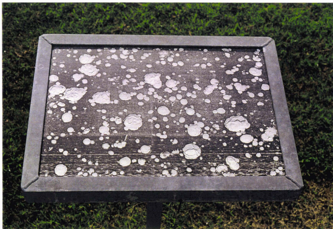
Photographie 2 - plaque grélimétrique (encrée) relevée le 5 juillet 1993 à Souyeaux(65) Echelle approximative : 1/4 Caractéristiques de la chute : 15 heures 30 HL, durée 10 minutes, diamètre de grêlon maximal : 34 mm, 3800 grêlons au m 2 , énergie : 515 J.m -2 ; masse : 2,92 kg.m -2 , (cliché : ANELFA)
