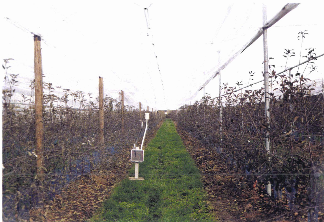
Photographie 24 - Mesures climatologiques sous un filet paragrêle structuré à plat.
