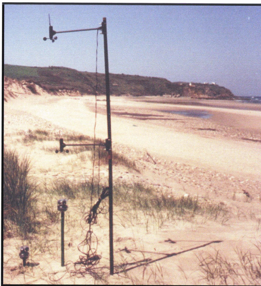
Photo n°19 : Matériel utilisé pour la réalisation de profils verticaux: les anémomètres sont disposés à différentes hauteurs (5 cm, 65 cm, 100 cm, 200cm). Photographie: Bonnet Langagne, 1997. Baie de Wissant, vue vers l'ouest
