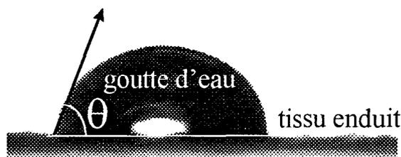
*Figure n° IV.15 : Goutte d'eau sur tissu enduit
