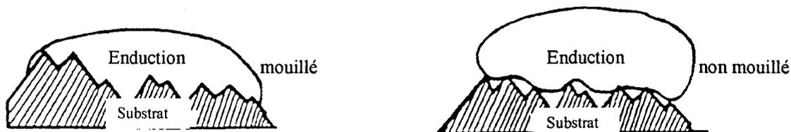
*Figure n° IV.16 : Effet des aspérités du substrat sur l'imprégnation de l'enduction*
