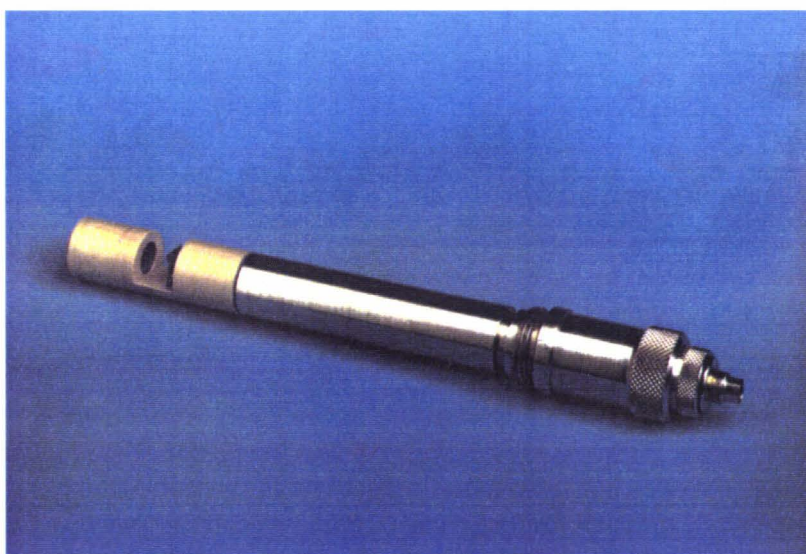
Figure 27 : Electrode double : de travail et de Pt.
