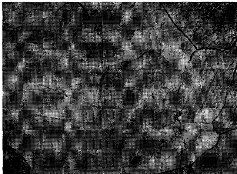
Figure 21 : Micrographie du barreau en alliage EC 720 coulé dans une lingotière métallique (X200).
