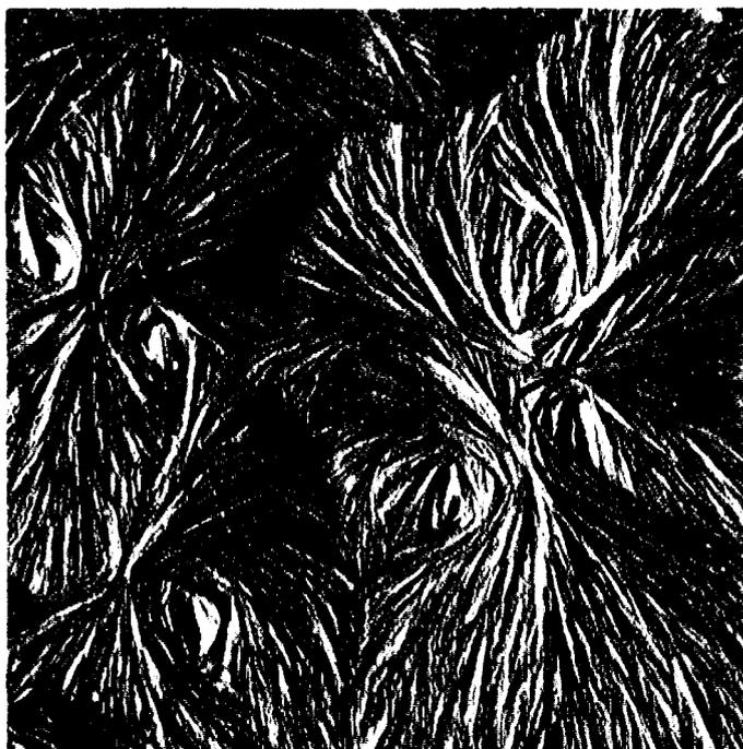
figure III- 31 : Image AFM (50 x 50  $\mu\text{m}$  ) en mode "amplitude" de la morphologie de surface d'un film de PA6-II cristallisé à  $T_s=236^\circ\text{C}$
