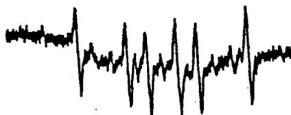
Figure 2.3 : spectre RPE de 3c (2mM) en présence de DMPO (3,2 mM) en milieu réducteur ( $-1,4$  V) dans une solution de DMSO à température ambiante. Les constantes de couplage sont :  $a_N = 14,7$  G et  $a_{H\beta} = 21,0$  G
