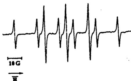
Figure 2.4 : spectre RPE de 3c (2mM) en présence de DMPO (3,2 mM) en milieu oxydant (+ 0,5 V) dans une solution de DMSO à température ambiante. Les constantes de couplage hyperfin sont :  $a_N = 15,75$  G et  $a_{H\beta} = 20,37$  G
