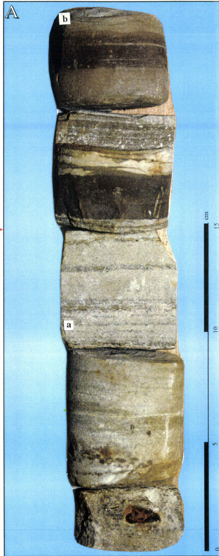
PLANCHE V.8 : Grès fins à grossiers à lamines planes, stratifications obliques et rides : A : Macrofaciès à lamines planes (marquées par de la matière organique végétale) passant à des grès fins à moyens à rides de courant vers le sommet : a. lamines planes, b. rides de courant. B : grès à empreintes de feuilles de végétaux avec deux séquences positives de puissance décimétrique : c. stratifications obliques, d. base de séquence.
