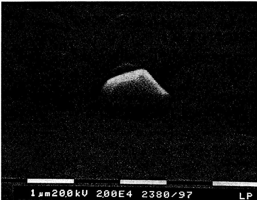
Figure A8 : Photographie MEB qui montre que cette excroissance est le prolongement vertical d'un grain d'aluminium.
