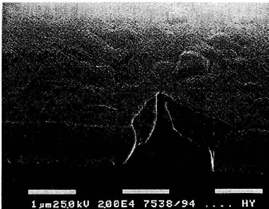
Figure A4 : Le cratère est de l'ordre de 1 μm et correspond à la taille d'un grain.
