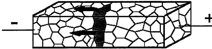
a) Déplacement de matière lors du passage d'un courant électrique.
