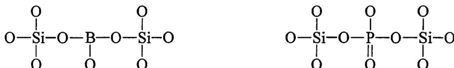
Figure B26 : Formes développées trivalente du bore et pentavalente du phosphore.
