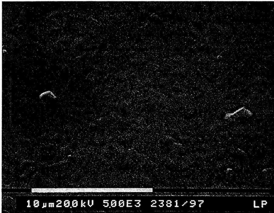
Figure A7 : Formation de monticules observés sur un dépôt d'aluminium effectué à 450°C après un recuit de 45 min à la même température.
