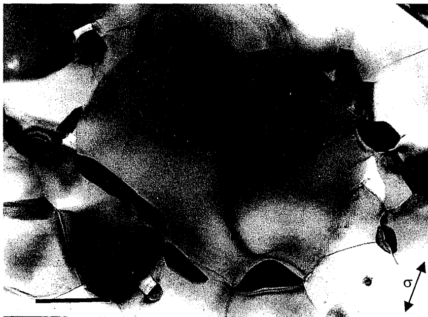
Figure III - 42 : Maintien de la forme équiaxée des grains le composite SZ30 déformé de 90% à 70 MPa et 1380°C. On note une faible porosité. Echelle : 1 \mu\text{m} .
