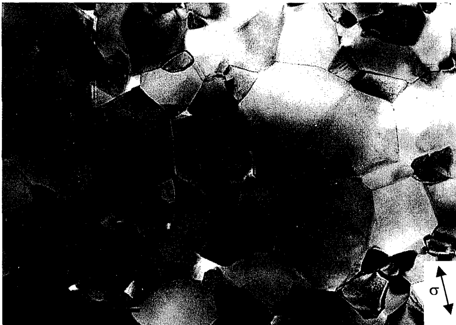
Figure III - 38 : Micrographie de MET montrant le maintien de la forme équiaxée des grains et l'absence de porosité après déformation à 1380°C sous \sigma=20-30-40 MPa dans le composite SZ5; \varepsilon_v=20\% . Echelle : 1 \mu\text{m}
