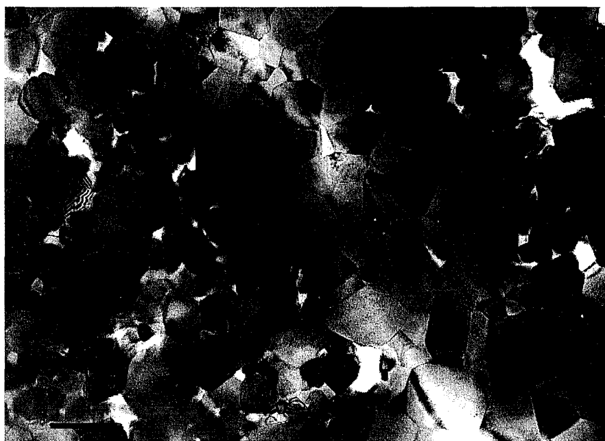
Figure III - 1: Micrographie de MEB (après attaque chimique) montrant la microstructure hétérogène du spinelle brut de frittage. Echelle : 2,5 \mu\text{m} .
