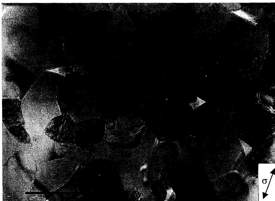
Figure III - 40 : Maintien de la forme équiaxée des grains et absence de porosité dans le composite SZ30 déformé à \sigma=20-30-40 MPa et 1380^{\circ}\text{C} ; \epsilon_v=36\% . Echelle : 1\ \mu\text{m} .
