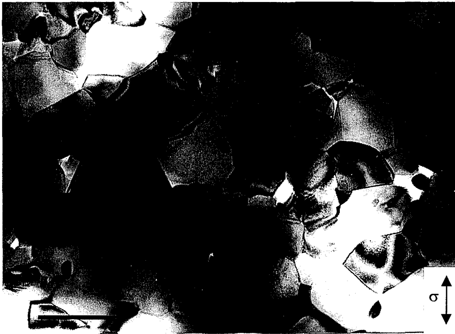
Figure III - 38 : Micrographie de MET montrant le maintien de la forme équiaxée des grains et l'absence de porosité après déformation à 1380°C sous \sigma=20-30-40 MPa dans le composite SZ5; \varepsilon_v=20\% . Echelle : 1 \mu\text{m}
