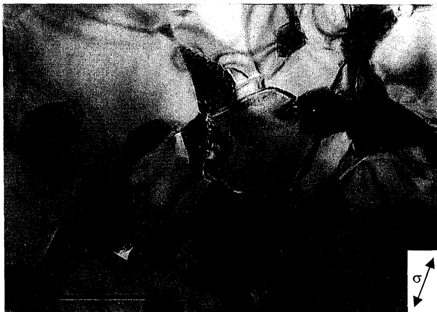
Figure III - 40 : Maintien de la forme équiaxée des grains et absence de porosité dans le composite SZ30 déformé à \sigma=20-30-40 MPa et 1380^{\circ}\text{C} ; \epsilon_v=36\% . Echelle : 1\ \mu\text{m} .
