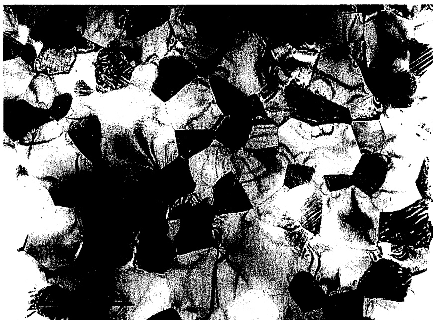
Figure III - 9: Micrographie de MET montrant la microstructure homogène du SZ30 brut de frittage. On note l'absence de porosité et de dislocations ainsi que la présence de macles dans certains grains de zircone. Echelle : 1 \mu\text{m} .
