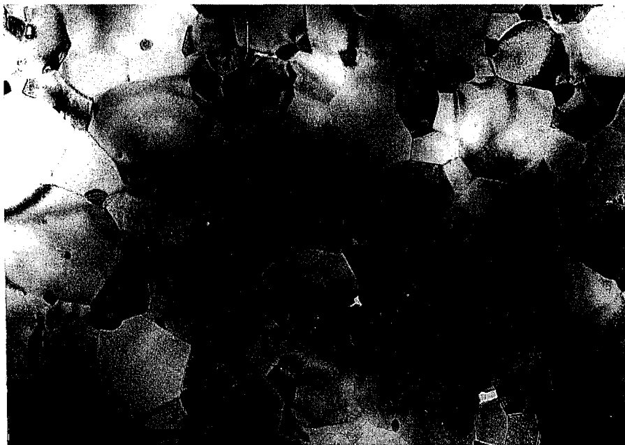
Figure III - 6: Micrographie de MET montrant l'absence de porosité et de dislocations dans le SZ5 brut de frittage. Echelle : 1 \mu\text{m} .
