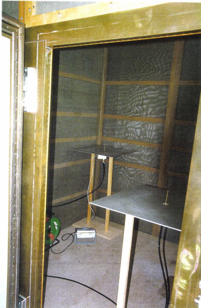
Figure 23: Dispositif de mesure reproduit en cage FARADAY
