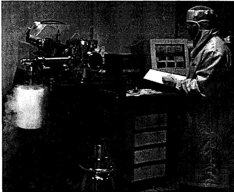
Photo III.1 : Dispositif de caractérisation électrique constitué d'un bâti sous vide et de son banc de pilotage par PC.
