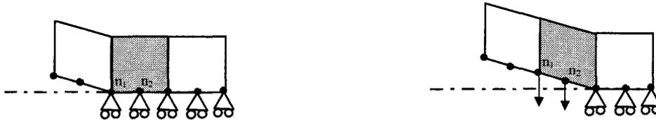
Figure 3. Procédure de relâchement des noeuds pour une structure symétrique.
