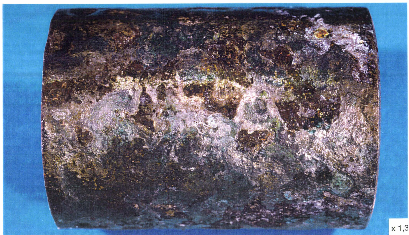
Figure 4-7 : examen macroscopique du tube en AISI 304L (durée de service : 11204 heures) ; Chaudière 2 de l'usine d'Issy-les-Moulineaux.
