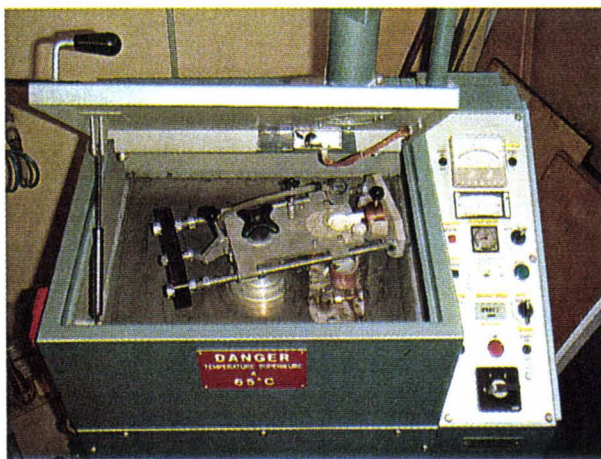
Figure 3-1 : four de fusion inductif ERSCEM CC8920.
